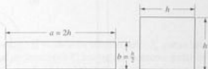
FIGURA 5-14 Comparación de la rigidez de secciones rectangulares y cuadradas a torsión. La sección cuadrada es dos veces más rígida que la rectangular, aun cuando ambas tienen la misma área: ab = h^2 .
