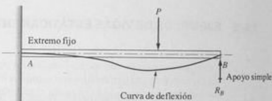
(c) Viga en voladizo apoyada
