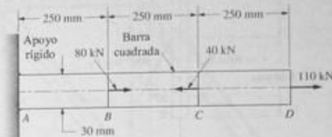
FIGURA 1-24 Barra del problema 1-47 que soporta cargas axiales.
