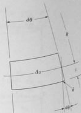
(b) Segmento de una viga deflexionada
