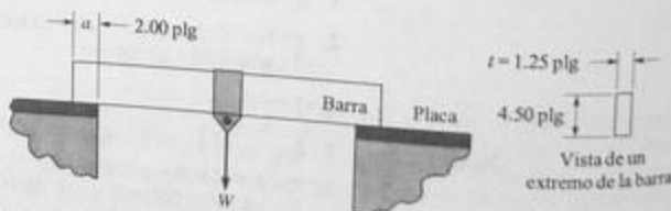
FIGURA 3-5 Viga del ejemplo 3-8.
